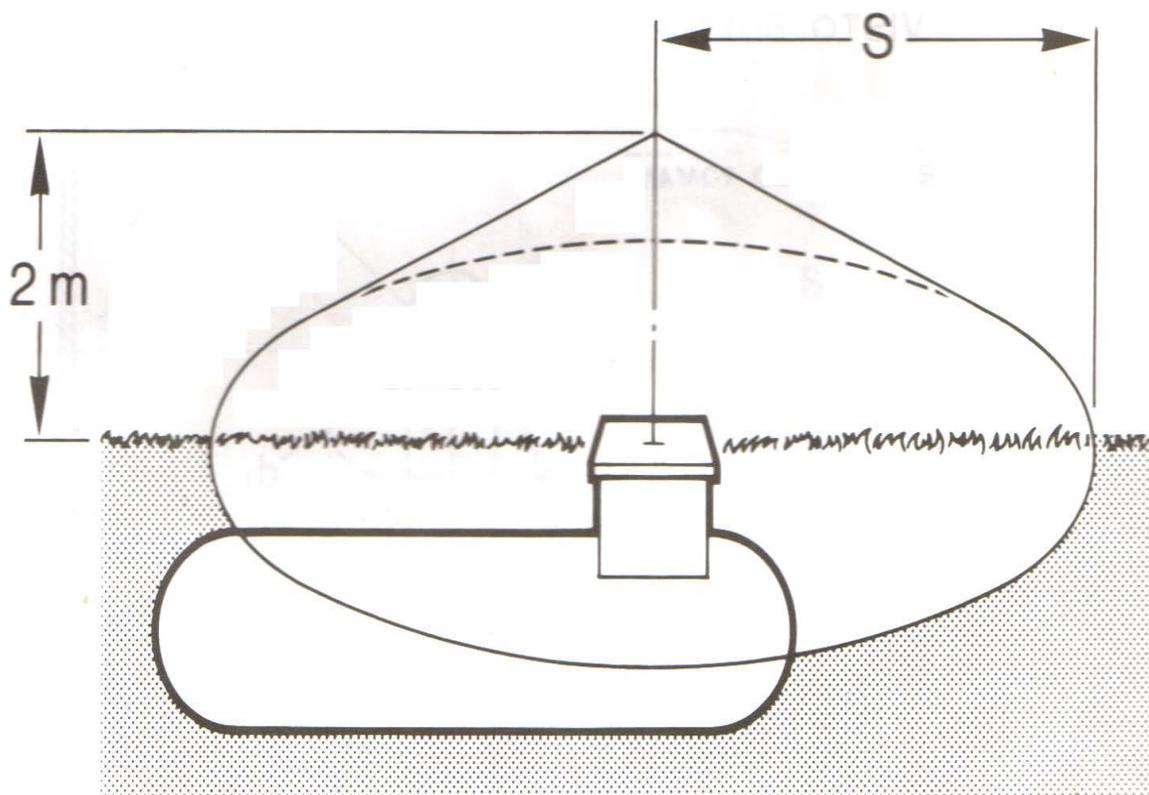
Figura 2.14. Volumen de seguridad correspondiente a una instalación enterrada.
