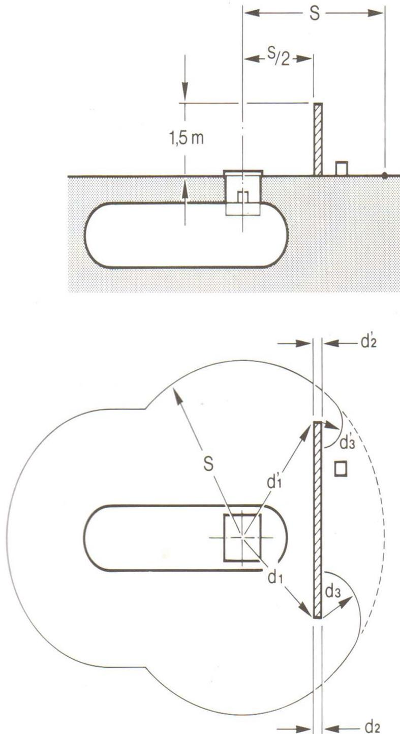
Figura 2.15. Modificación de la distancia y volumen de seguridad de una instalación enterrada por un muro o pantalla.
