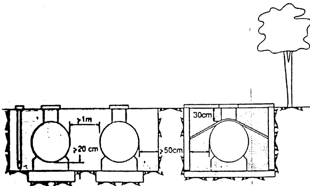
Figura 4.- Tanques enterrados.
