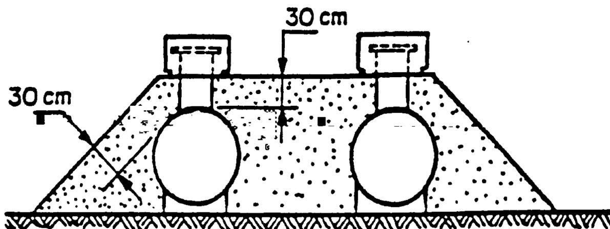
Figura 3.- Tanques en talud
