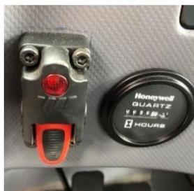
5. Poner el camión a un régimen de rotación de 800rpm a 1000rpm usando el acelerador manual. Nota: no acelerar nunca con la toma fuerza accionada a más de 1000rpm porque podría causar roturas la toma fuerza.
