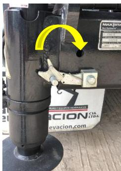
4. Accionar la extensión del soporte estabilizador posterior completamente.
