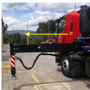
2. Accionar la extensión del cilindro estabilizador frontal de modo que apoye firmemente en el suelo.
