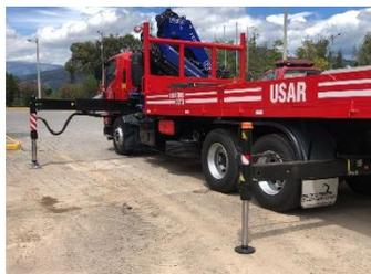
6. Estabilizar el vehículo en un plano horizontal con una tolerancia máxima de 1,5 ° de inclinación.
