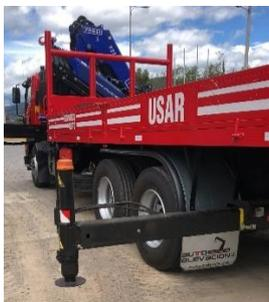
5. Accionar la extensión del cilindro estabilizador posterior de modo que apoye firmemente en el suelo.
