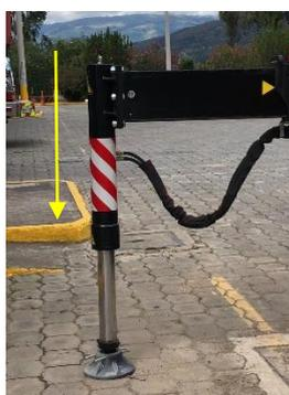
3. Desenganchar el dispositivo de bloqueo manual del soporte estabilizador posterior.
