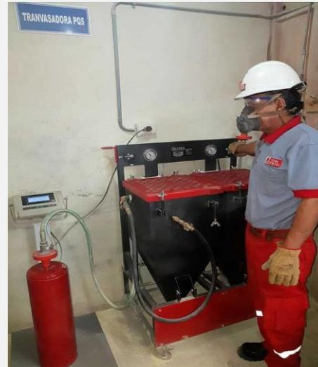
**02** Cuando en la inspección o mantenimiento del extintor verificamos que el polvo está en mal estado. (compactado, grumos, bolas, húmedo).
