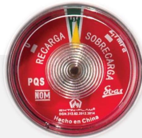
Manómetro del extintor en el **rango operable.**
