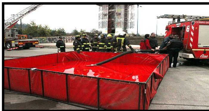
Gráfico 8. Abastecimiento mediante succión piscina de agua.
