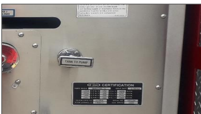
Gráfico 14. Válvula de paso de agua de tanque a bomba
