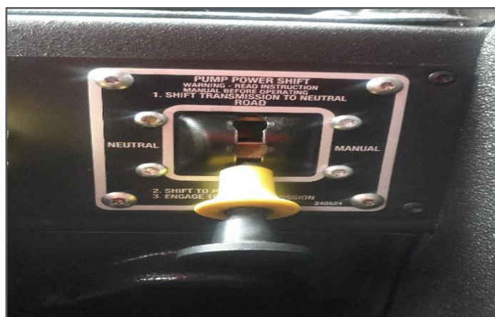
Gráfico 10. PTO posición engage truck transmission
