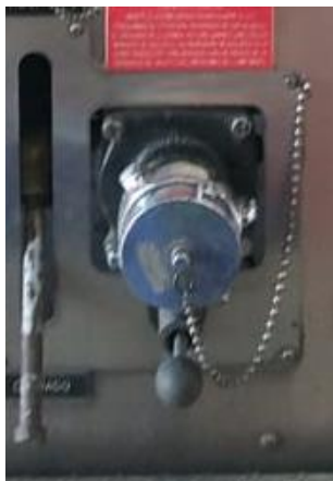
Gráfico 24. Toma de hidrante de la autobomba
