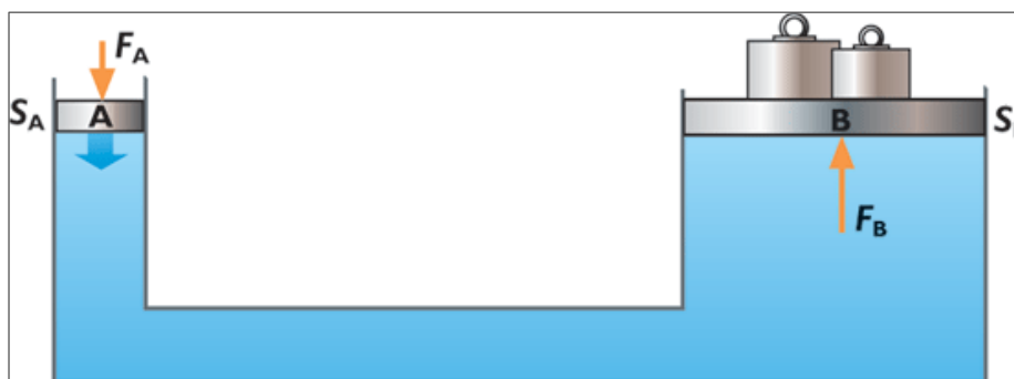
Gráfico 2. Fuerzas que interactúan bajo el principio de Pascal.
