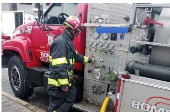
Gráfico 8. Apertura de la válvula de paso de agua de tanque a bomba
