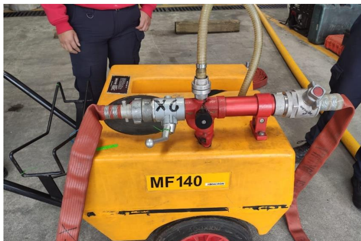
Gráfico 18. Apertura de válvula de ingreso de agua
