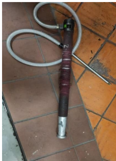
Gráfico 11. Eductor de espuma con pitón.
