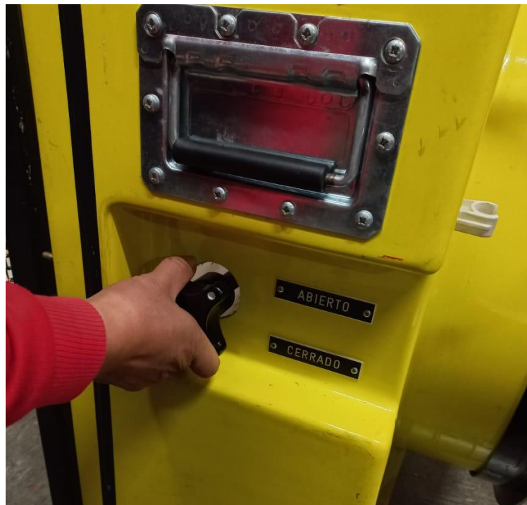
Gráfico 25. Colocación en modo abierto del sistema del Fomax 7
