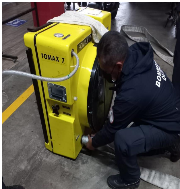
Gráfico 21. Conexión de manguera de 2 ½ "al generador Fomax 7
