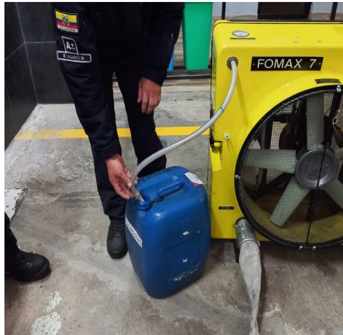
Gráfico 22. Colocación de solución espumante
