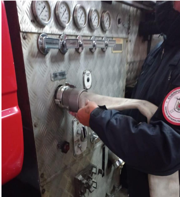
Gráfico 20. Conexión de manguera de 2 ½ "a vehículo de abastecimiento
