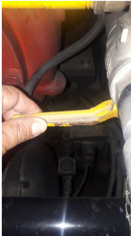
Gráfico 44. Cierre de paso de espumógeno
