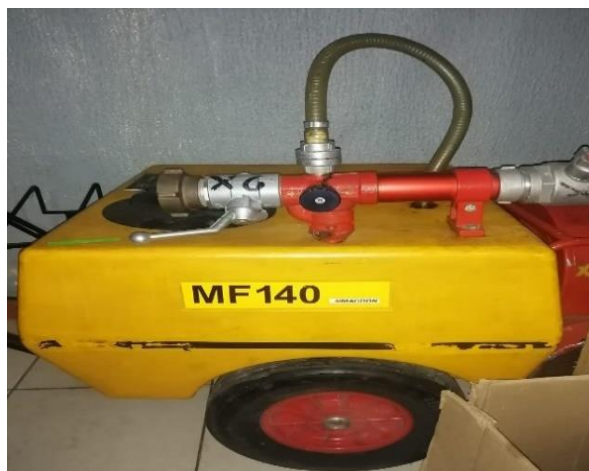
Gráfico 13. Eductor de espuma móvil
