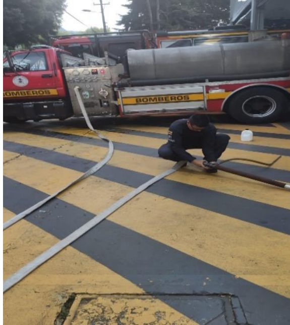
Gráfico 28. Acoplamiento de la manguera
