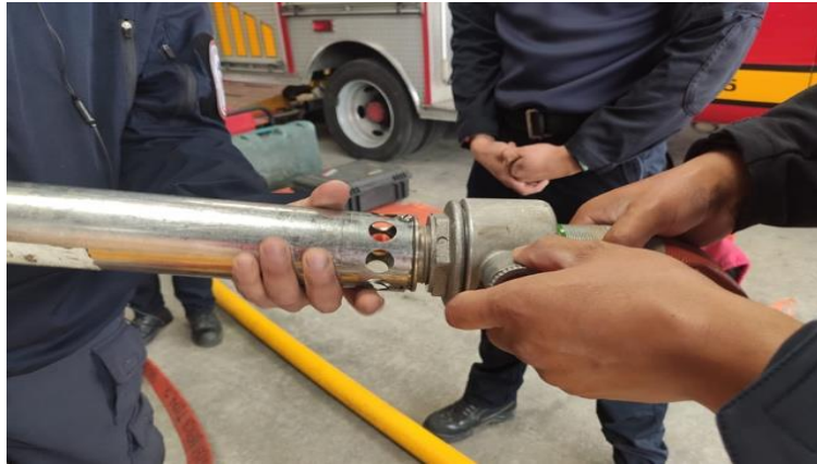
Gráfico 15. Acople de la manguera de descarga
