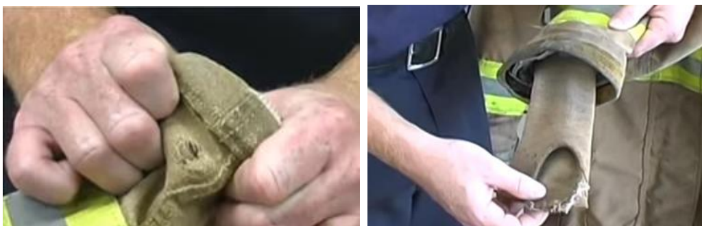
Gráfico 2. Daños en capa exterior
