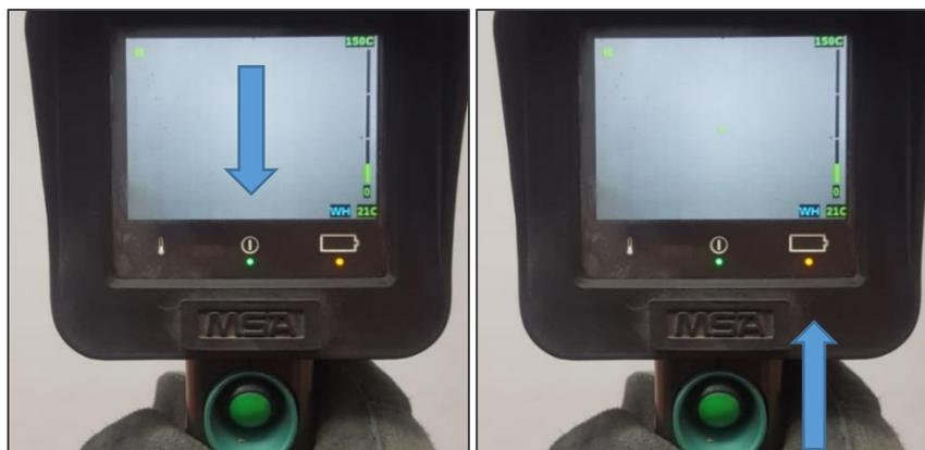
*Gráfico 2. Encendido y verificación de batería de TIC*
