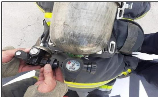
*Gráfico 24. Conexión de manguera de alta presión*
