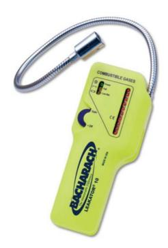
Este equipo nos permite verificar en una area determinada la existencia o no de un VOC (Compuesto Organico Volatil), las luces led que posee el equipo subirá su intensidad luminosa, indicandonos que en el lugar existe un compuesto organico volatil, de igual manera posee una alarma sonora que indica de la misma manera un VOC existente.
