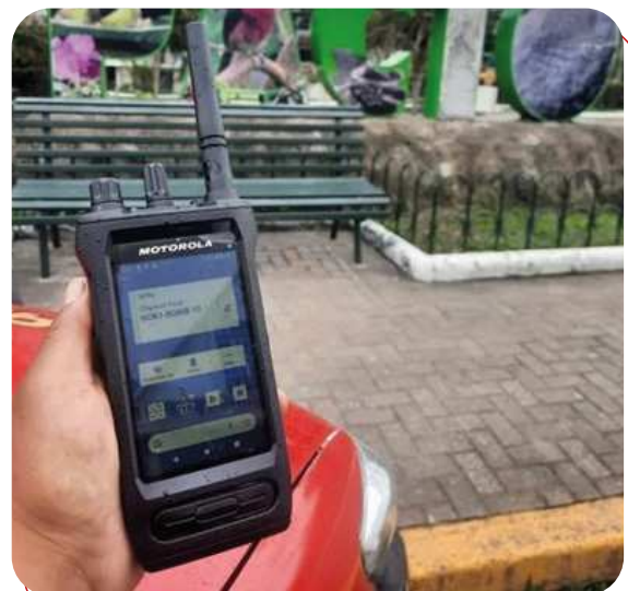
Fuente: DTC - Uso de radios con tecnología LTE en zonas sin cobertura de sistema de la red del CBDMQ.
